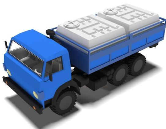
Ёмкость предназначена для перевозки агрохимических растворов в концентрированном виде или рабочих растворов для опрыскивания. Центр тяжести снижен в сравнении вертикальными цилиндрическими емкостями на 500 мм, что улучшает устойчивость автомобиля при перевозке и маневрировании.
